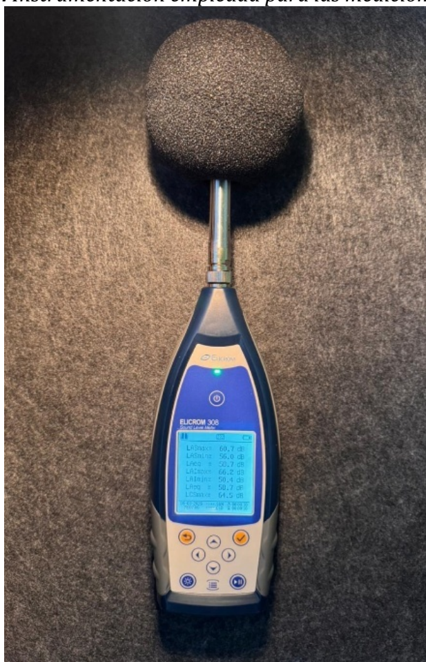
Imagen 3. Instrumentación empleada para las mediciones de ruido
