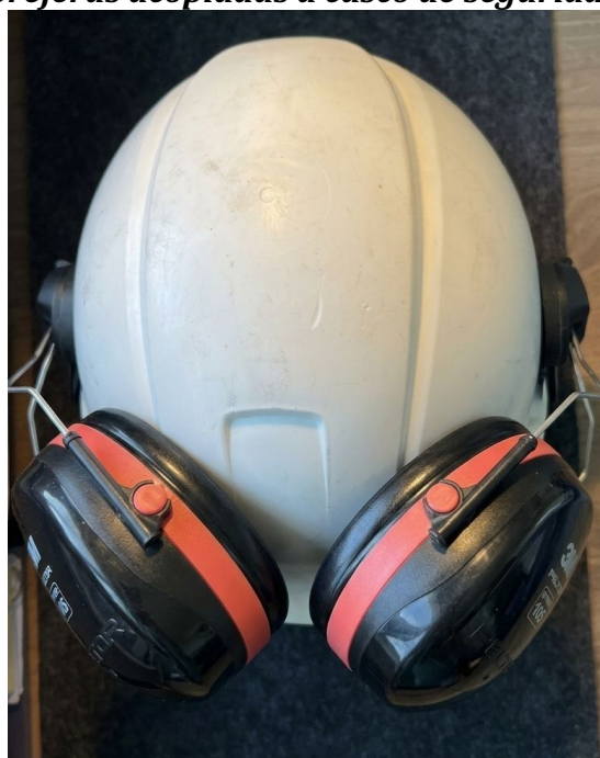
Imagen 4. Equipo de protección auditiva utilizado para el análisis de atenuación (orejeras acopladas a casco de seguridad).
